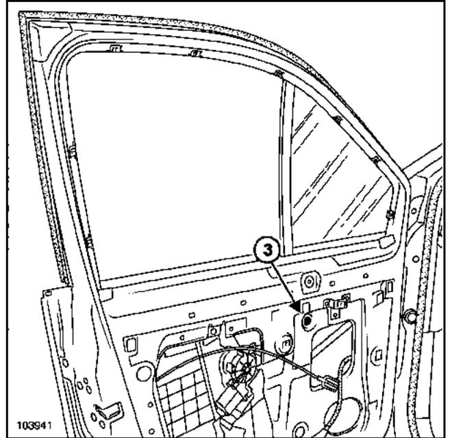
Déposer la vis inférieure (3) du montant fixe.
