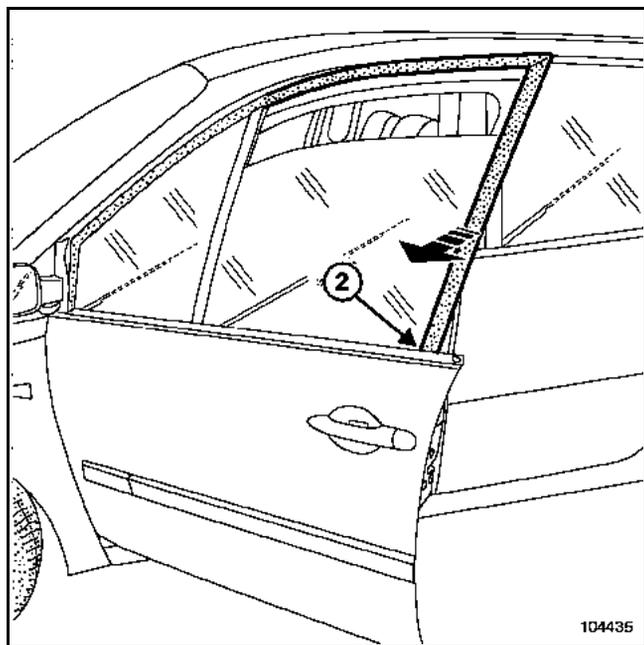
Dégager le joint d'encadrement de derrière le panneau (2).
