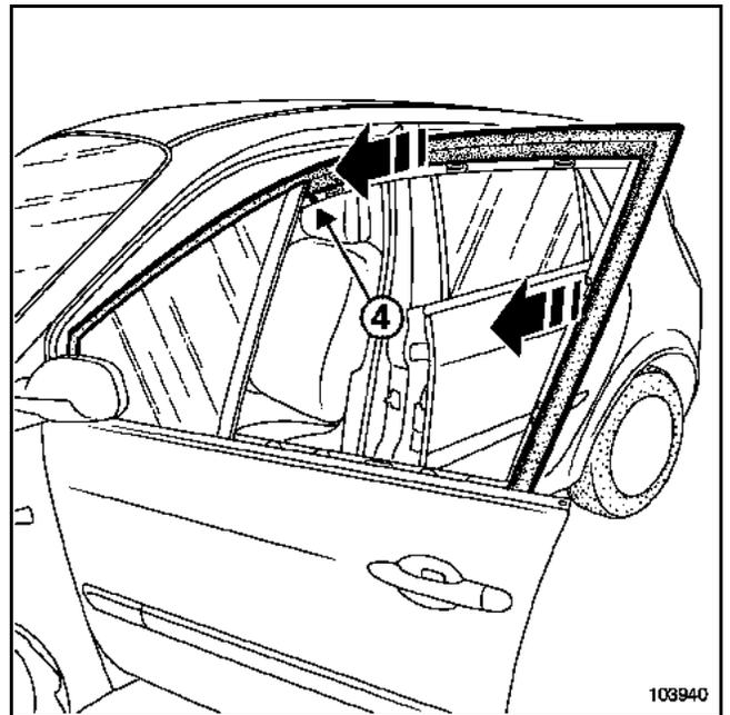
Déposer la vis supérieure (4) du montant fixe.
