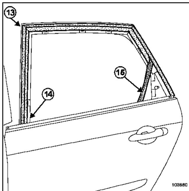
Positionner et chausser le joint à l'angle (13) en prenant soin de le glisser derrière le panneau (14).
