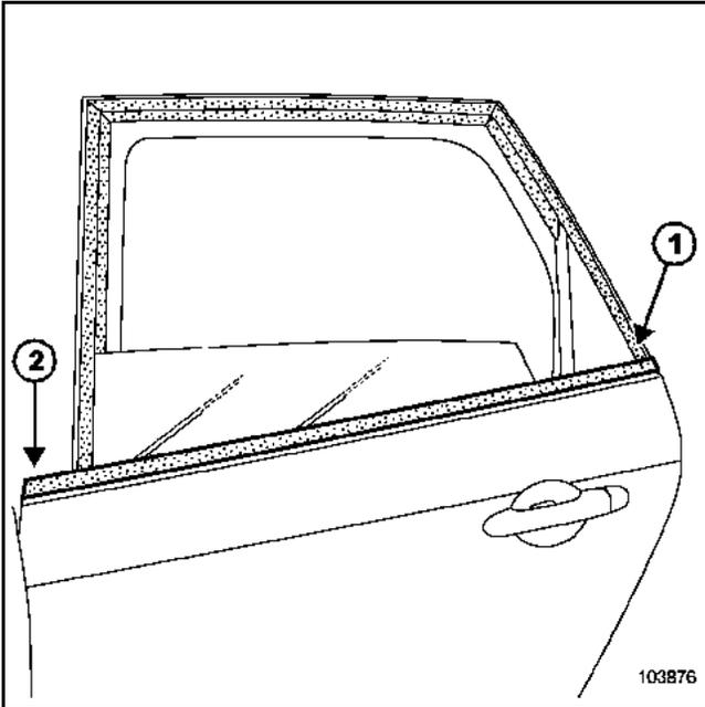
Dégager soigneusement le lécheur extérieur (1) et (2) à l'aide de l'outil (Car. 1363).
